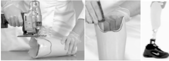
Fig.23 Taglio, levigatura e montaggio componenti
